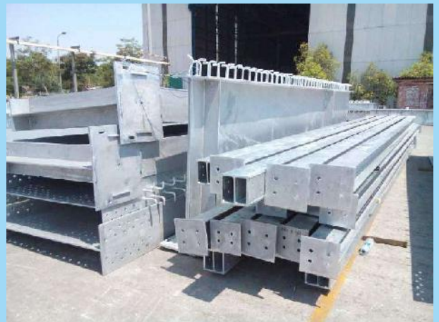
Komponen Jembatan Girder 40 M
